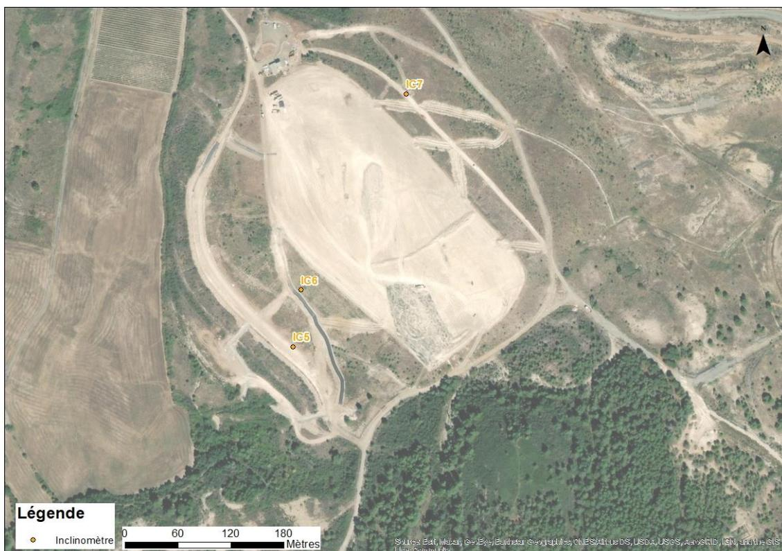
*Illustration 26 : Localisation des inclinomètres IC5, IC6 et IC7 sur le stockage de Montredon.*
