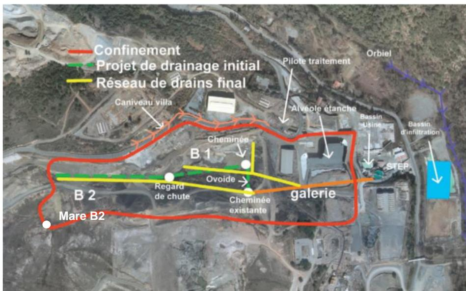
Illustration 57 : Zone de confinement de l'ADEME et réseau de drainage (ADEME, 2006).
